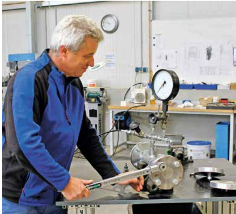
Anlagenmonteur Uwe Gläser kontrolliert per Druck ein Rohr auf Dichtheit.
